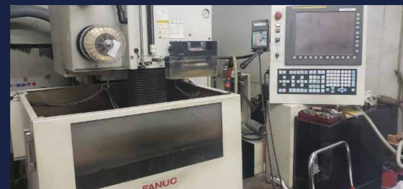
①ワイヤーカットという機械を使い、銅のブロックを切り出します。
