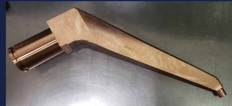
④バリや溶着などに注意しながら、お客様の求める精度に近付けていきます。
